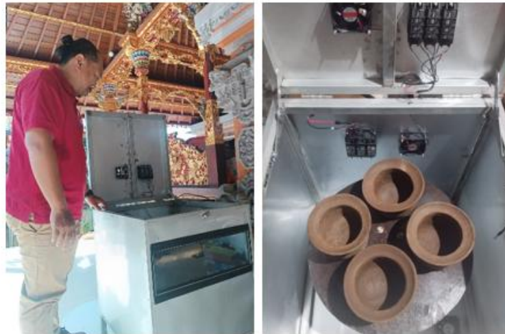
Gambar 5. Implementasi alat pengering gerabah berbasis mikrokontroler
